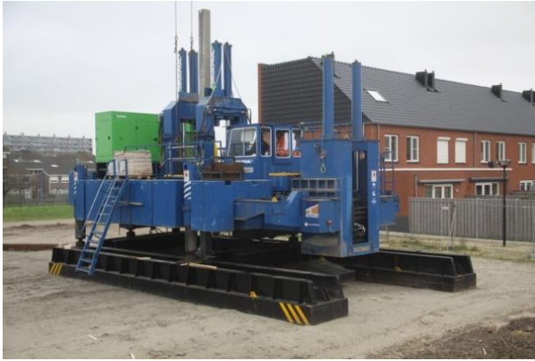
Figuur 26: Hydraulische indrukininstallatie voor prefab-betonpalen (links) en hydraulische indrukininstallatie voor damwanden (rechts) (bronnen: www.drukpaal.nl & https://www.sterk.eu/ )
