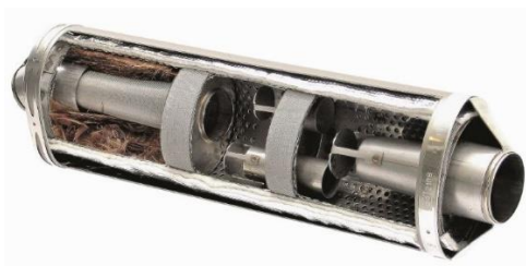
Figuur 19: Doorsnede van een uitlaatdemper met meerdere kamers
